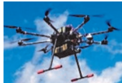
Спектрорадиометр SPECTRAL EVOLUTION PSR+ установленный на БПЛА.
